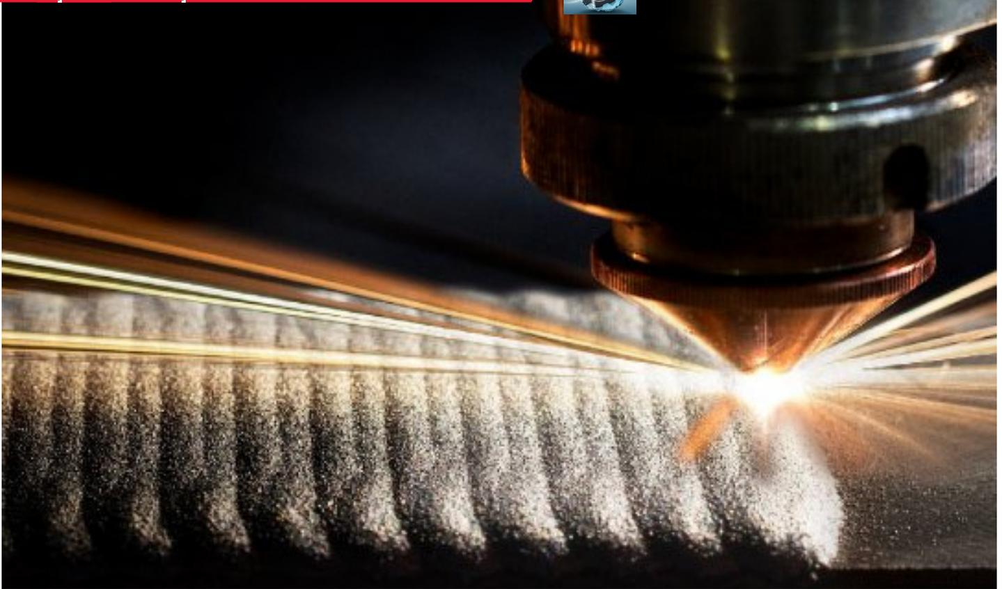
Durit nutzt Laser-Cladding u. a. zum Beschichten von Ventil- und Pumpenbauteilen
