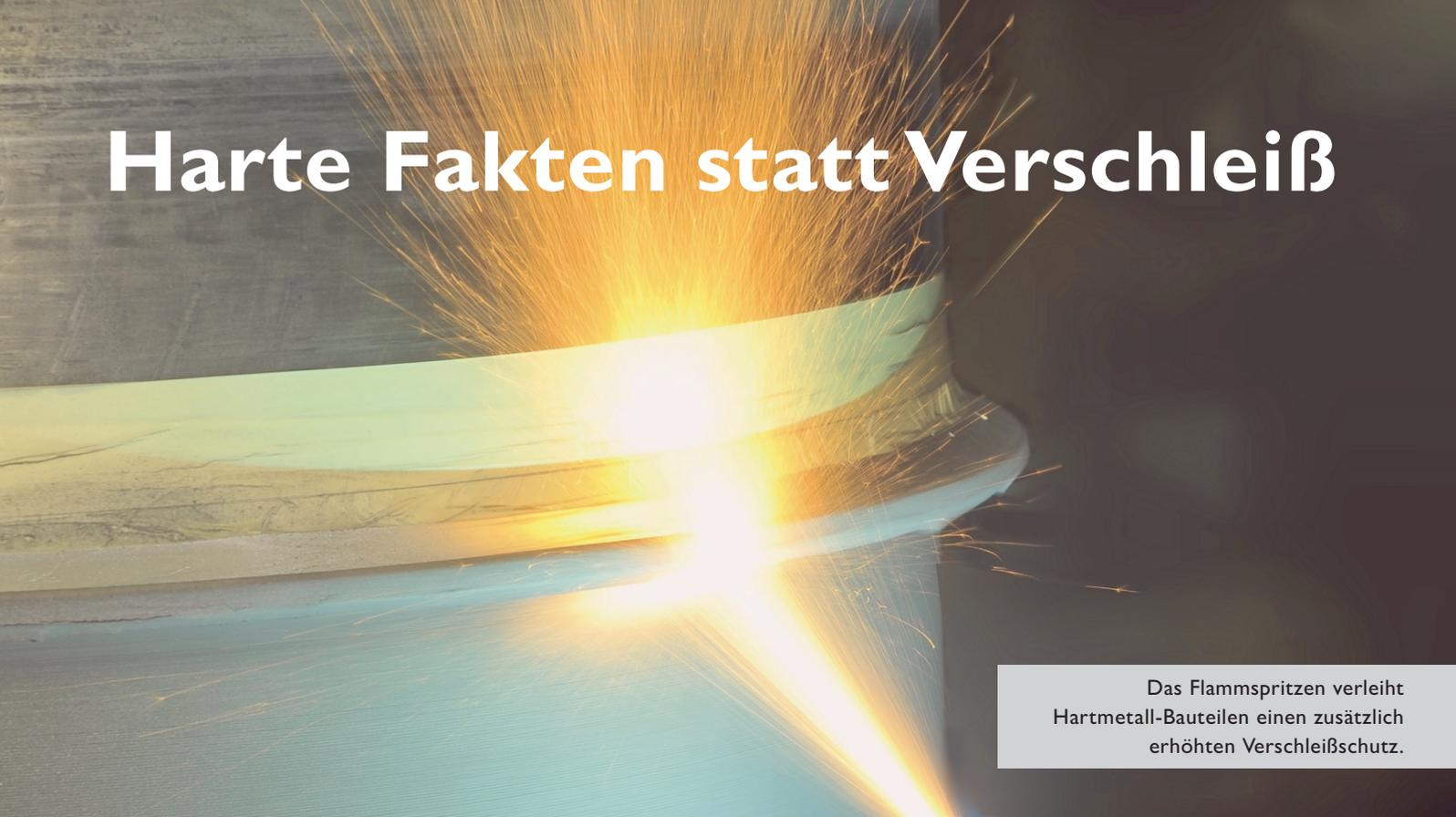
Das Flammstritzen verleiht Hartmetall-Bauteilen einen zusätzlich erhöhten Verschleißschutz.
