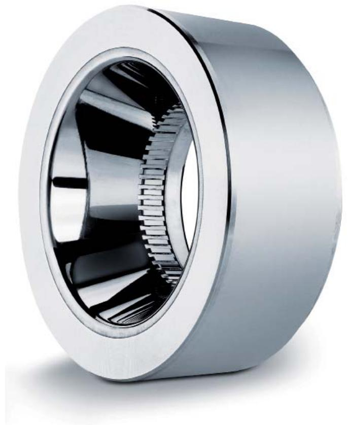
gesteigerten Standzeiten (bis 15 Prozent). Die Wahl der Hartmetallsorte hängt von dem zu ziehenden Material ab. Ziehmatrizen werden aus einer Stahl-Hartmetall-Kombination gefertigt. Der Vorteil liegt darin, dass der unmittelbare Verschleißbereich aus Hartmetall besteht und die Fassung aus einem geeigneten Stahl, der den Hartmetallring unterstützt und die Zugkräfte der auftretenden Schubspannungen auffängt. Da der Werk-
