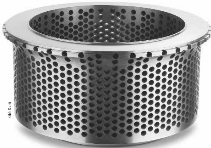
Der Ventilkäfig aus dem Hartmetall GD08NC mit einem speziellen Chrom/Nickel-Binder zeigt eine deutlich stärkere Resistenz gegen Verschleiß als gehärteter Werkzeugstahl
